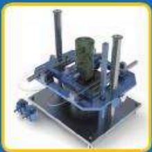
CAV径向波速各向异性测试装置 测量地应力主应力方向
