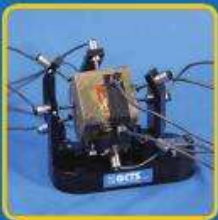
DSA动态应变测试装置 测量立方体试样三向地应力
